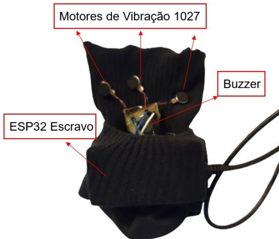
Figura 38 – Posicionamento dos motores de vibração na pulseira de feedback tátil.
