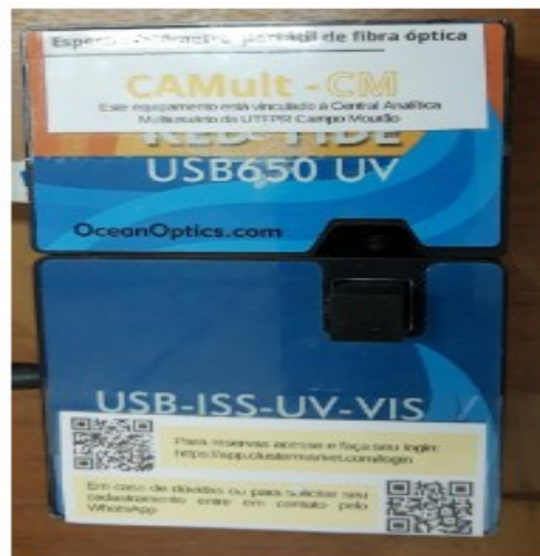
Figura 12: Espectrofotômetro portátil de fibra
