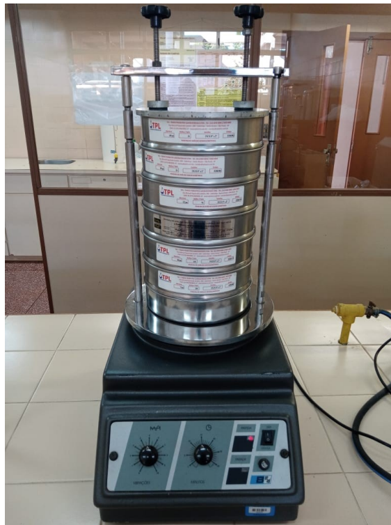
Figura 3 - Ilustração do equipamento eletromagnético para análises granulométricas.
