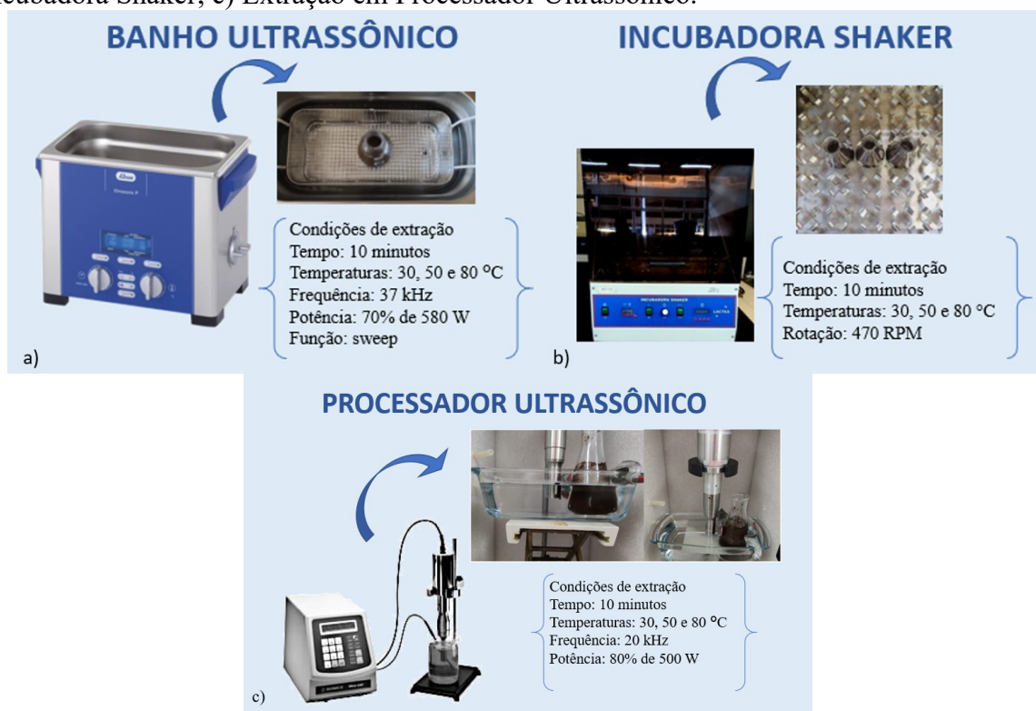
Figura 7 - a) Extração sólido-líquido em Banho Ultrassônico; b) Extração sólido-líquido em Incubadora Shaker; c) Extração em Processador Ultrassônico.
