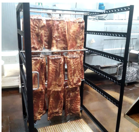
Figura 2- Barrigas suínas com fumaça líquida, distribuídas no carrinho de cozimento, antes do processo térmico em estufas
