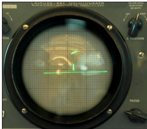
Imagem 1 – Funcionamento do Tennis for Two na tela de um osciloscópio
