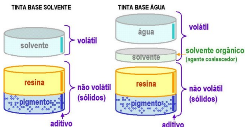
Figura 8 – Composição básica de tintas à base de água e base de solvente
