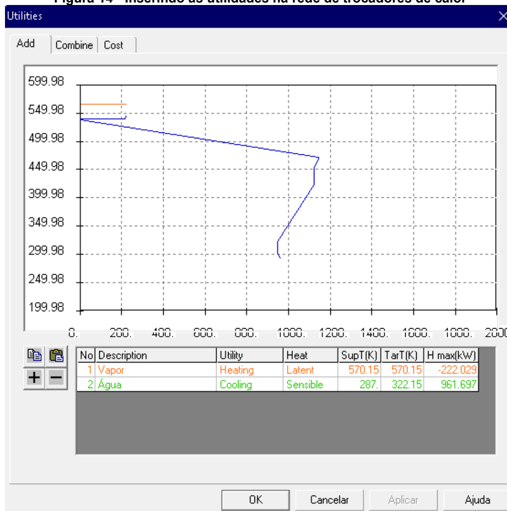
Figura 14 - Inserindo as utilidades na rede de trocadores de calor
