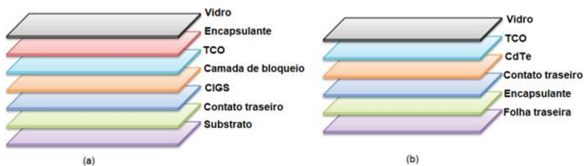
Figura 6 - (6a) Estrutura básica painel CIGS. (6b) Estrutura básica painel CdTe. Fonte: Adaptado de Lunardi et al. (2009).
