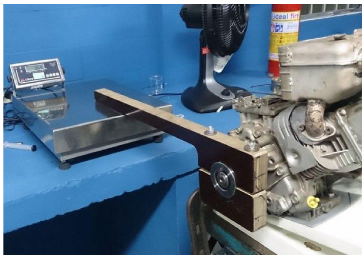
Figura 1 – Bancada dinamométrica que utiliza o freio de Prony.
