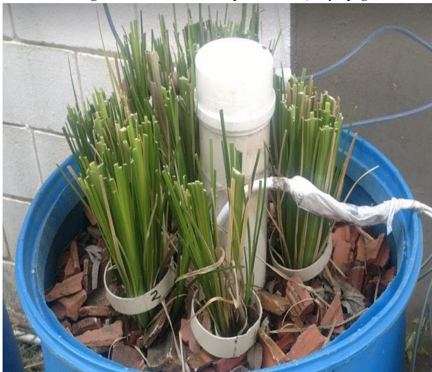
Figura 9: Sistema WCVA 1 vegetado com mudas de capim Vetiver ( Chrysopogon zizanioides L. Roberty)
