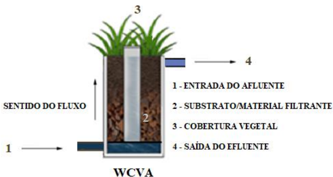
Figura 2: Esquema de funcionamento de um sistema de WCVA
