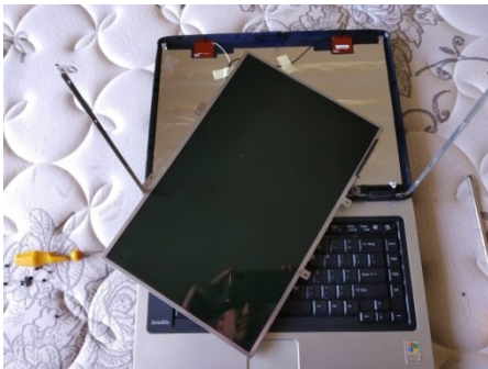
Figura 14: Notebook (lixo eletrônico) para retirada da película polarizadora
