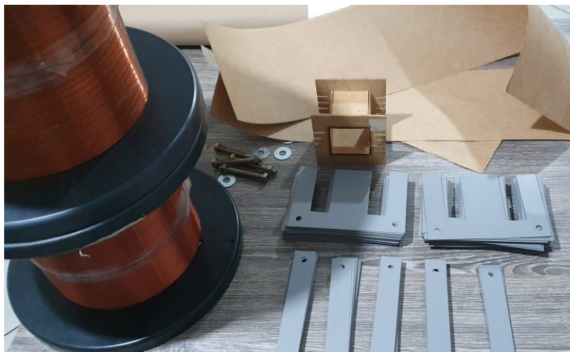
Figura 4 - Material necessário para a implementação do transformador.
