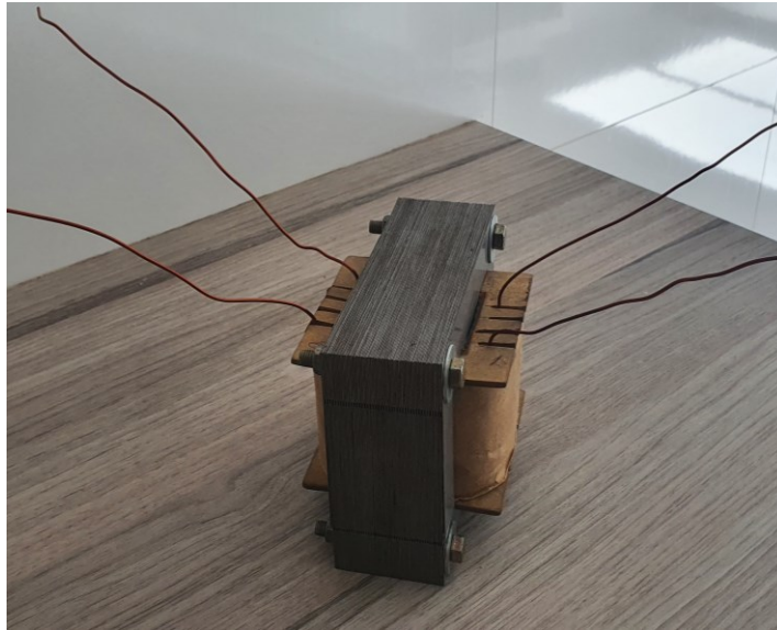
Figura 16 - Resultado final do transformador, vista lateral.
