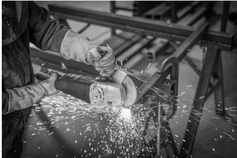
Figura 10 – Esmerilhadeira utilizada para o /corte de metais
