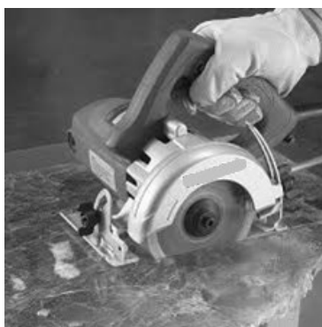
Figura 9 – Serra mármore utilizada no corte de mármore
