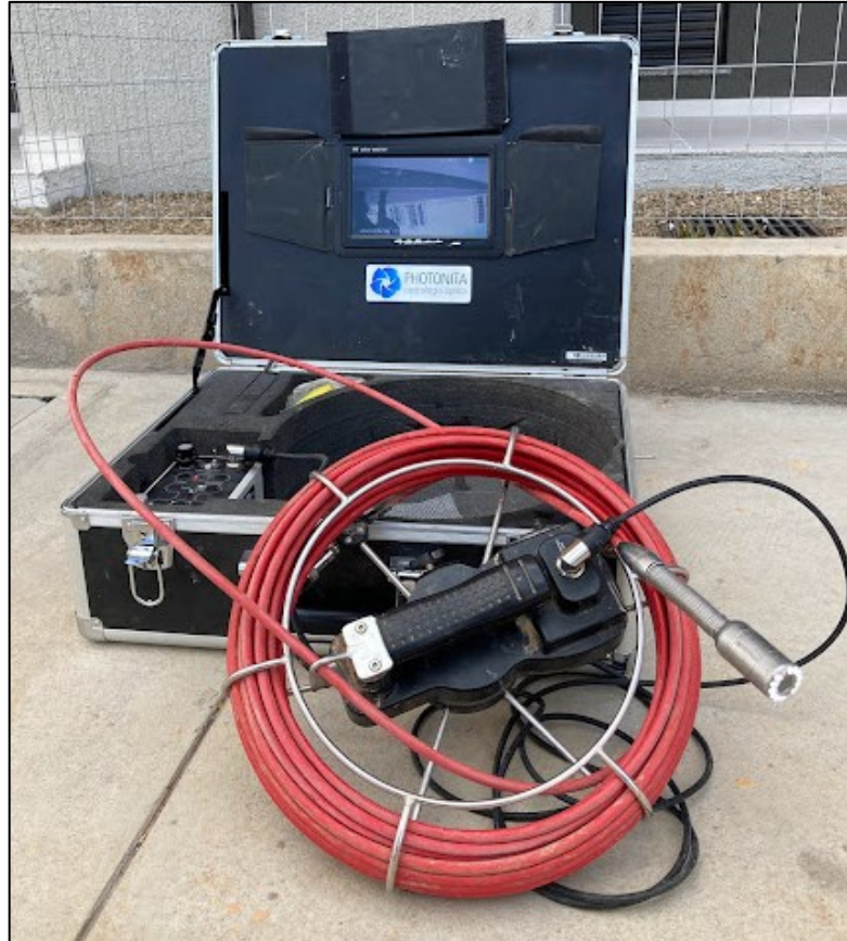
Fotografia 6 – Endoscópio industrial utilizado na obra B.
