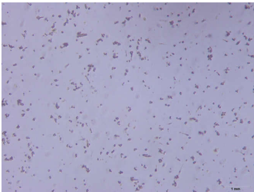
Figura 34 – Partículas de enxofre formadas no ensaio E9 – 15 minutos
