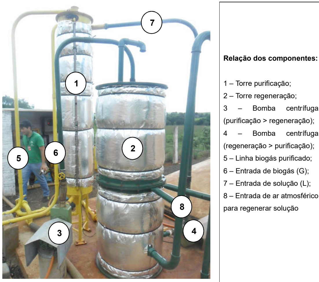
Figura 12 – SPB1 e relação de componentes
