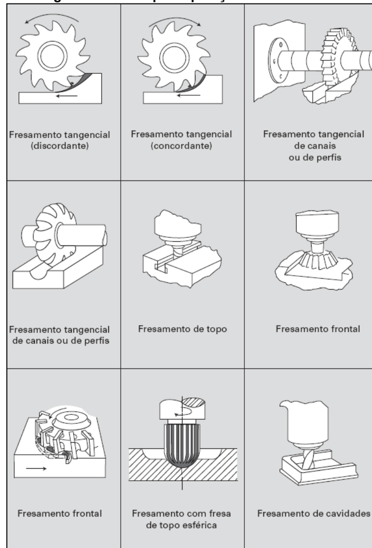
Figura 15 – Principais operações de fresamento
