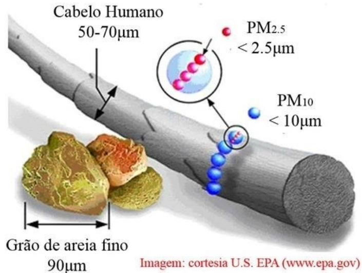
Figura 2 – Comparação do tamanho do PM_{2,5} e PM_{10} com fio de cabelo e grão de areia
