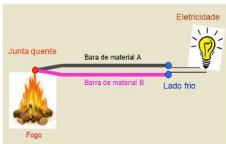
Figura 7: Ilustração demonstrando o efeito Seebeck
