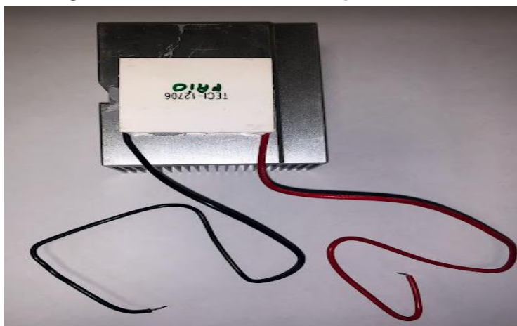
Figura 21: Pastilha Peltier e dissipador de calor.
