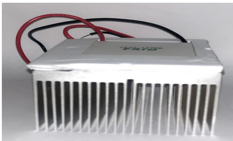
Figura 23: Dissipador de calor, com pastilha Peltier, visão lateral.
