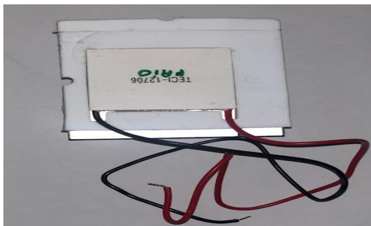
Figura 22: Pastilha Peltier, EVA e dissipador de calor.
