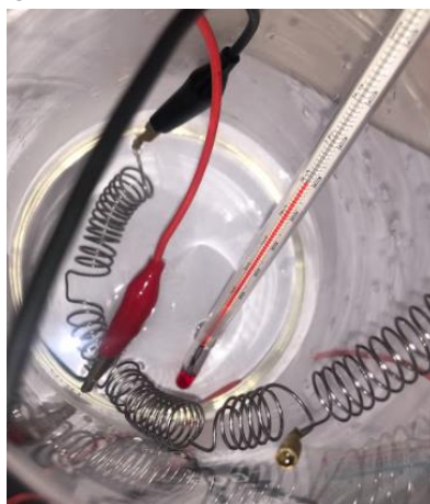
Figura 13 - Aquecedor feito com resistência de chuveiro.
