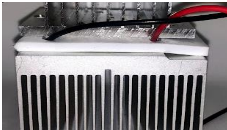
Figura 24: Dissipador de calor maior, Pastilha Peltier, EVA e dissipador de calor menor.
