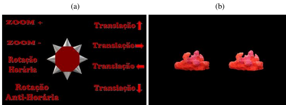
Figura 63 – Janelas do possível visualizador: (a) tela principal com botões e (b) secundária com projeção do par estéreo para polarização da luz.
