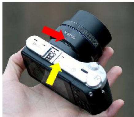
Figura 38 – Câmera com os pontos: seta vermelha é o centro da lente e seta amarela é a posição do sensor
