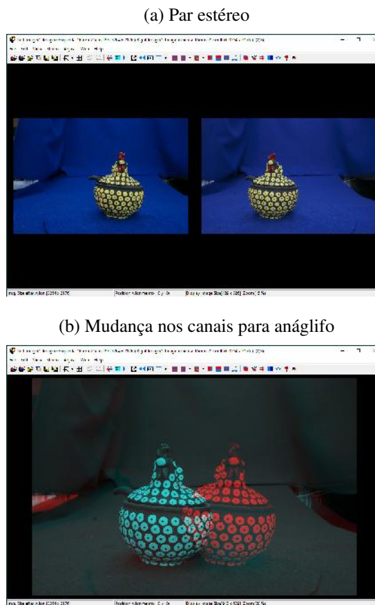
Figura 69 – Preparação do par estéreo com distância de 25cm entre câmera e objeto - StereoPhoto Maker
