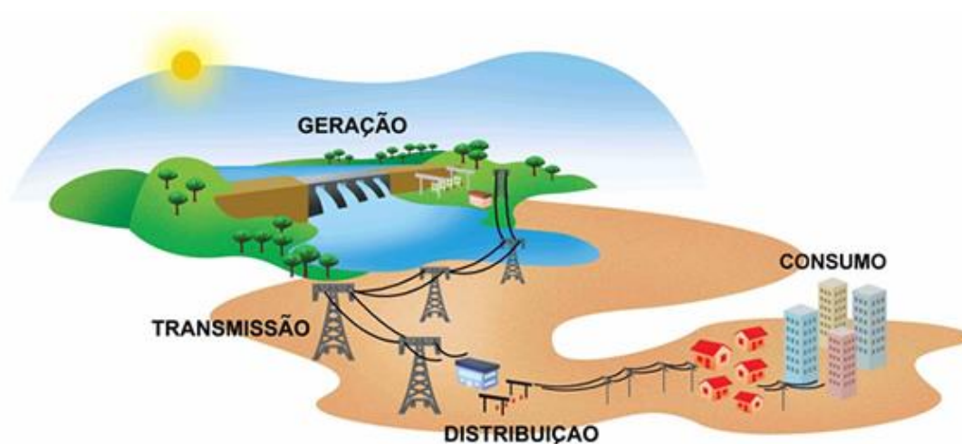
Figura 4 - Etapas do fornecimento da energia elétrica.
