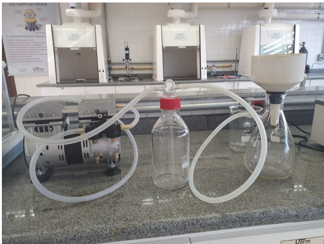
Fotografia 3 – Montagem dos equipamentos para filtragem à vácuo
