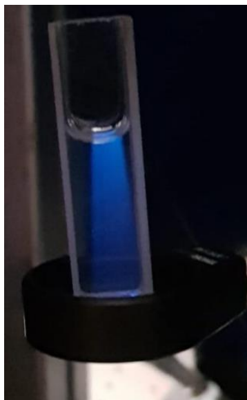
Figura 41 - Laser de Nitrogênio pulsado incidindo nos PQs de W em água bidestilada. Nota: o laser incide a partir da parte de cima da cubeta e, ao excitar os PQs presentes na amostra, ocorre fotoluminescência visível a olho nu.
