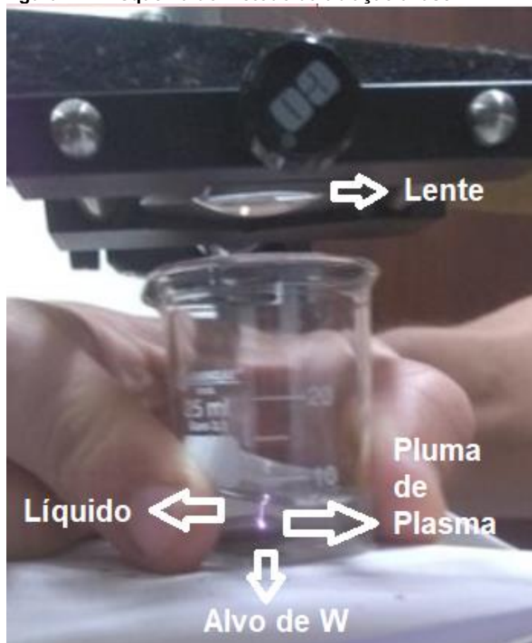
Figura 22 – Esquema do método da ablação a laser.
