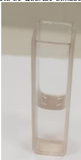
Figura 25 - Cubeta de Quartzo utilizada nas medições.
