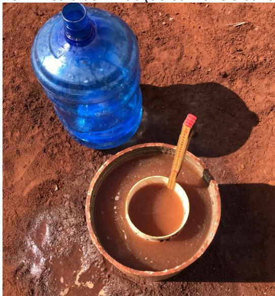
Figura 15 - Ensaio de infiltração com anéis concêntricos
