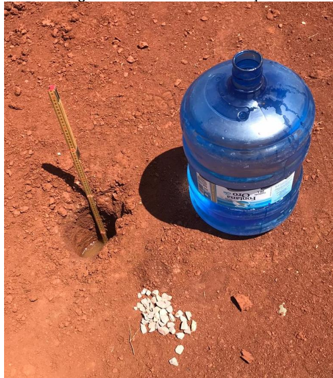
Figura 13 - Ensaio de infiltração
