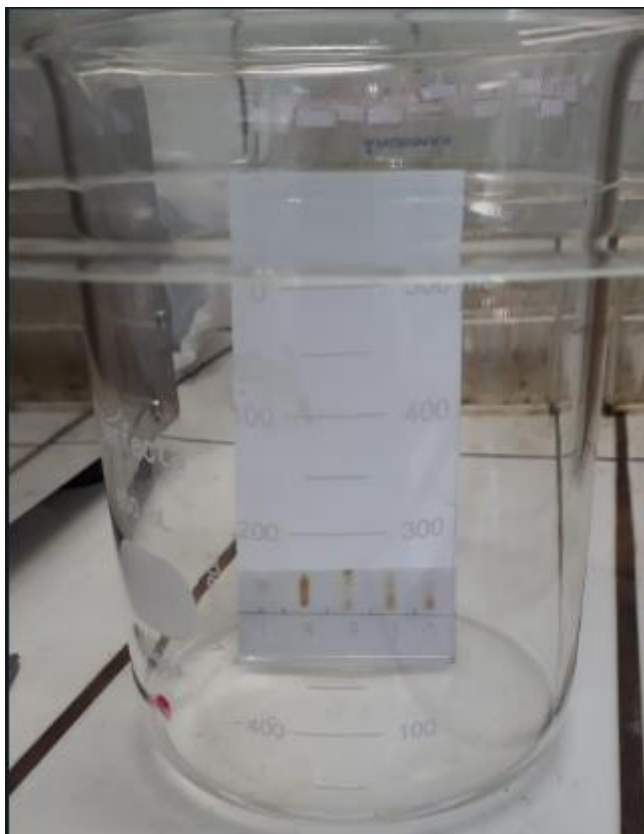
Figura 12 - A avaliação do perfil cromatográfico das frações obtidas foi monitorada por CCD analítica. Fonte: autoria própria (2021)
