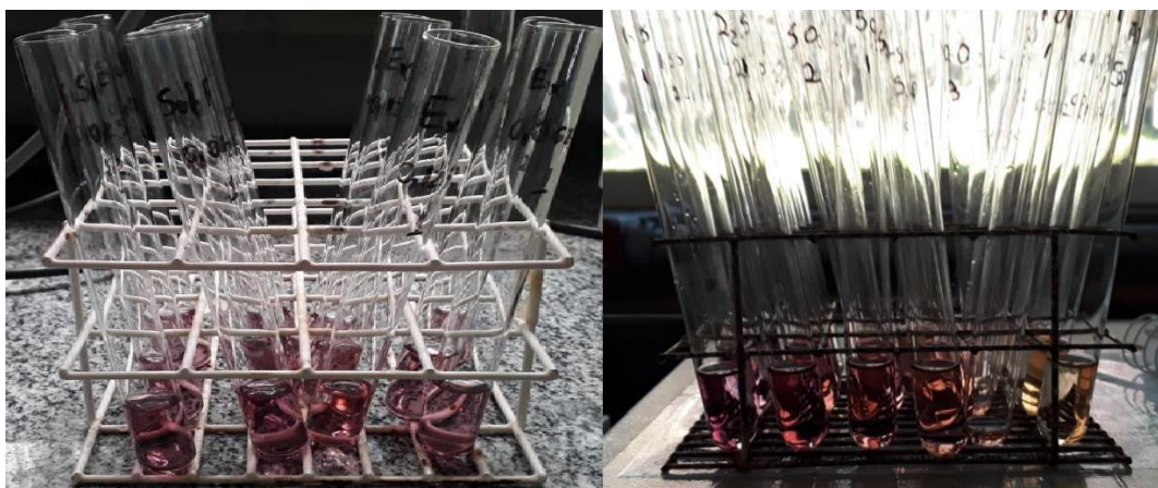
Figura 14 – Ensaio atividade antioxidante pelo método de sequestro do radical DPPH• Fonte: autoria própria (2021)
