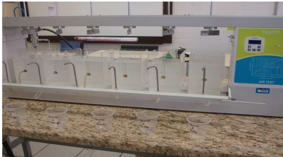
FIGURA 1 - Jar Test contendo as amostras antes do início da rotação Fonte: Autores
