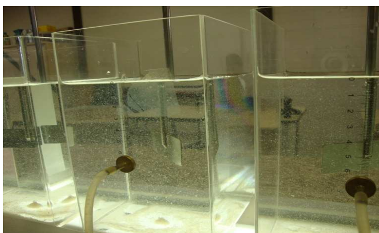
FIGURA 2 - Jar Test contendo as amostras do processo de sedimentação. Fonte: Autores.
