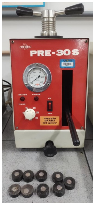
Figura 9 – Equipamento utilizado para embutimento a quente e amostras embutidas
