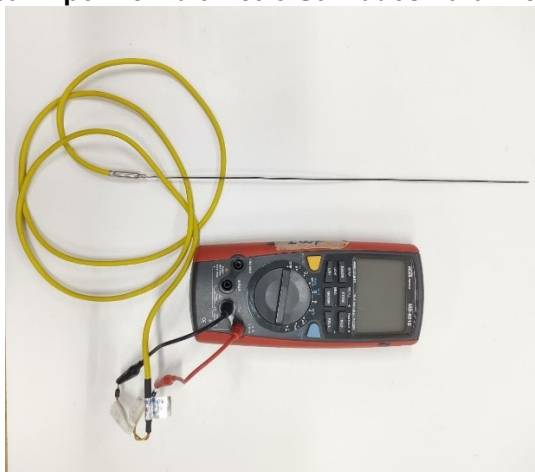
Figura 16 – Termopar Tipo K e Multímetro Utilizados Para Aferir as Temperaturas
