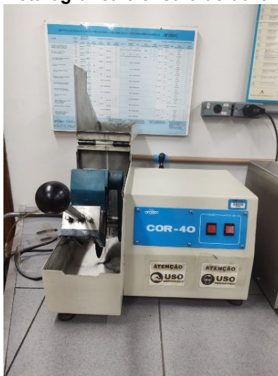
Figura 7 – Policorte Arotec utilizada para retirada das amostras para caracterização metalográfica e ensaio de dureza
