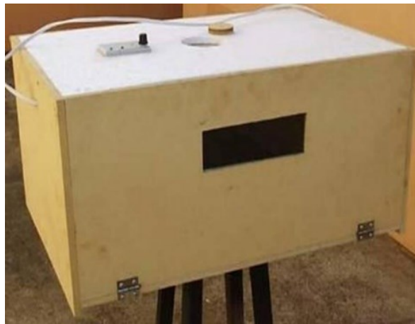
Figura 6 - Chocadeira com revestimento em madeira
