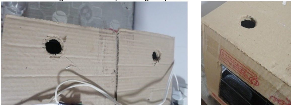
Figura 4 – Furos para oxigenação e saída de calor.
