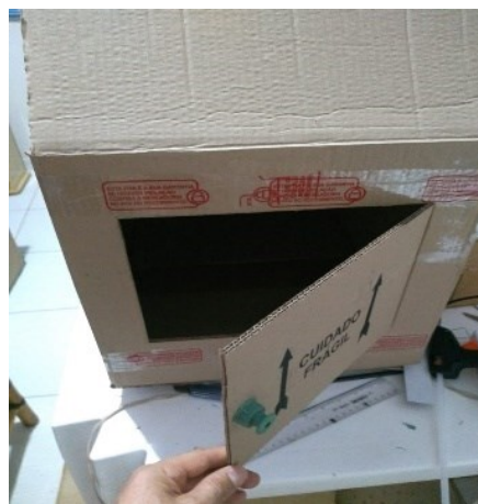
Figura 7 - Chocadeira com revestimento em papelão.
