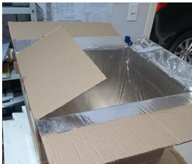
Figura 10 - Revestimento interno da chocadeira.
