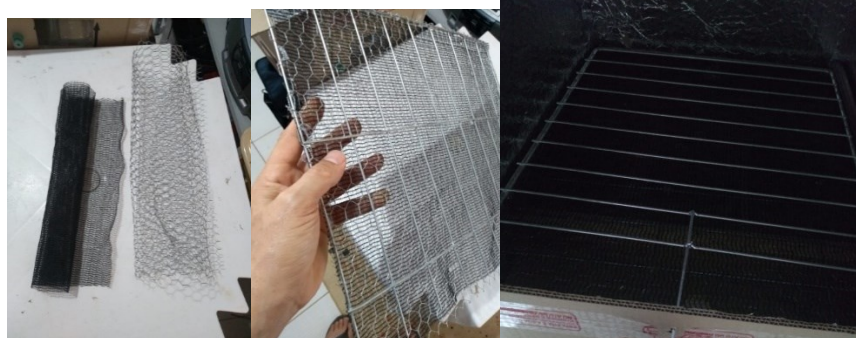
Figura 02 – Colocação da tela e grelha de proteção na chocadeira.
