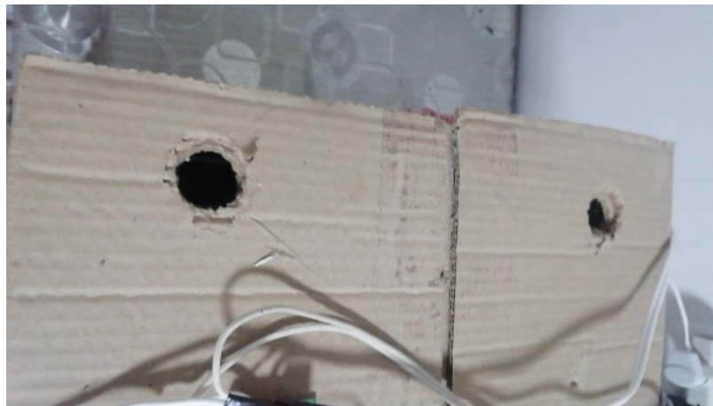
Figura 13 - Furos para oxigenação e saída de calor.
