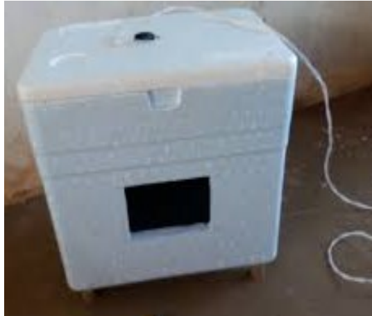
Figura 8 - Chocadeira com revestimento em isopor.
