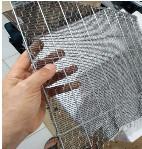
Figura 11 - Colocação da tela e grelha de proteção na chocadeira.
