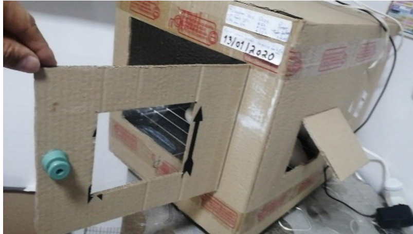
Figura 12 - Aberturas para ventilação e visualização do espaço interno.
