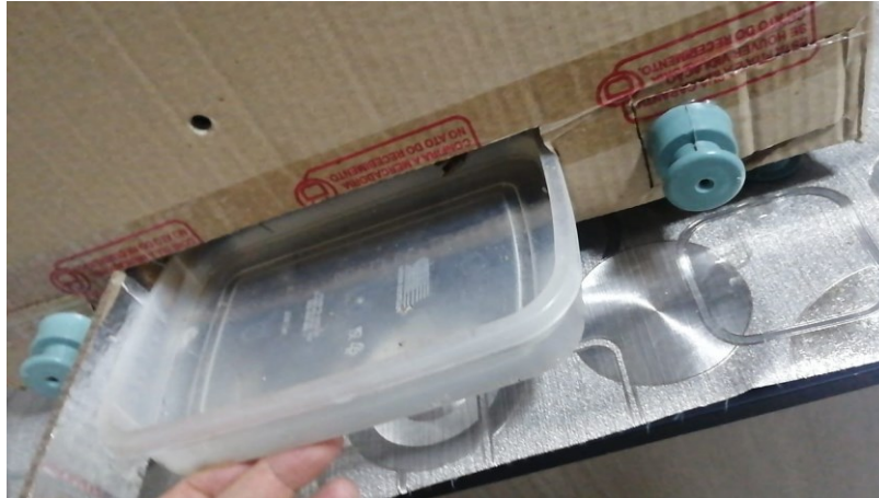
Figura 14 - Colocação de recipientes com água na parte inferior da chocadeira.
