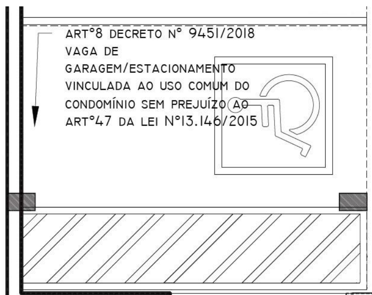
Figura 13 – Detalhe da vaga de estacionamento reservada
