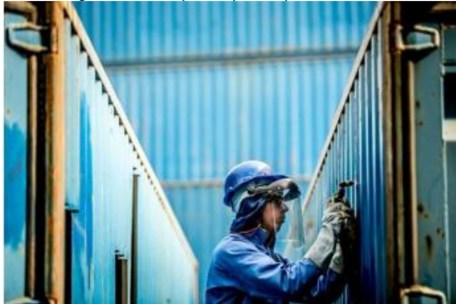
Figura 9 - Corte a plasma para esquadrias
