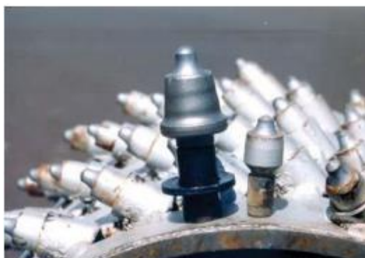
Figura 4 - Ponta de corte da fresadora
