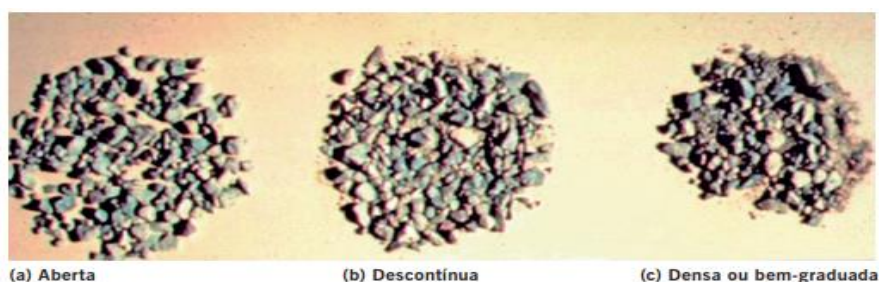
Figura 4.2 Exemplos de composições granulométricas dos tipos de misturas a quente
