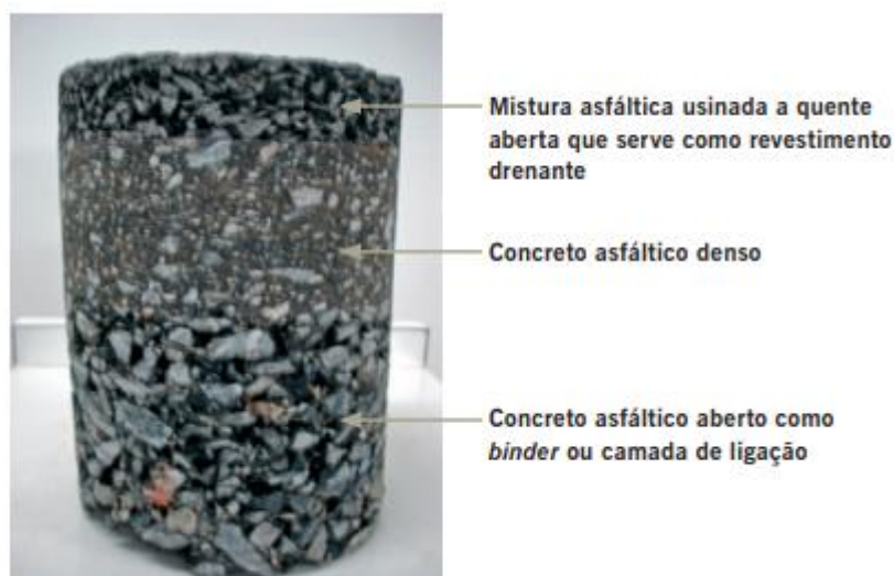
Figura 3 - Corpo de prova retirado de um pavimento
