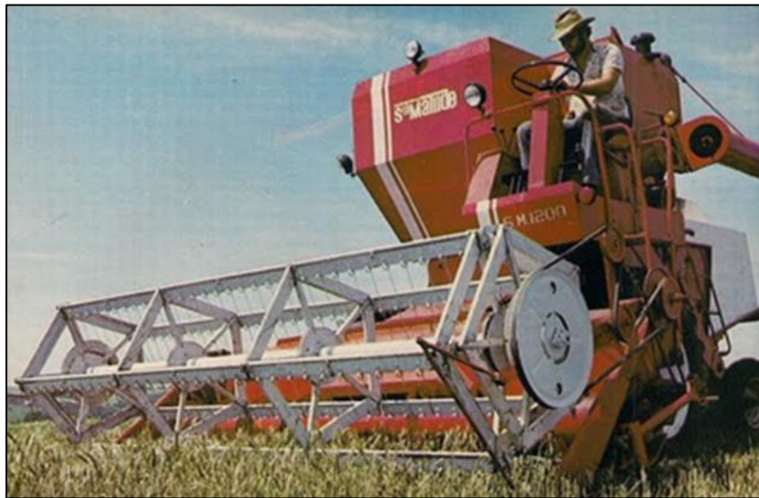
Figura 15 - Plataforma de colheita da SM 1200 Fonte: Adaptação TRATORES, (2015).
