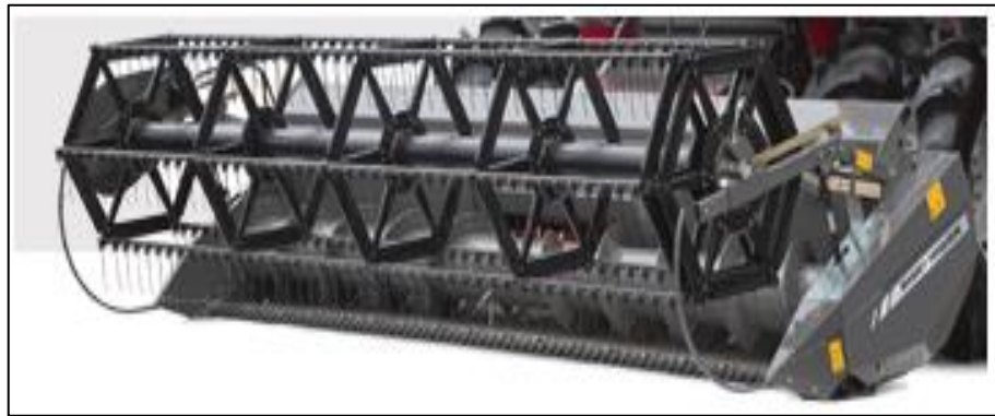
Figura 20 - Plataforma Rígida Fonte: Adaptação MASSEY FERGUSON, (2015).
