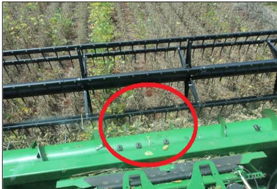
Figura 27 - Dedos retráteis em ataque Fonte: Autoria própria.
