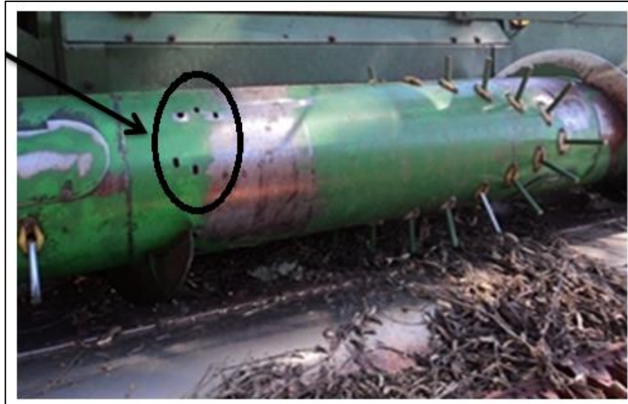
Figura 2 B - Falta de dedos alimentadores Fonte: Autoria Própria.
