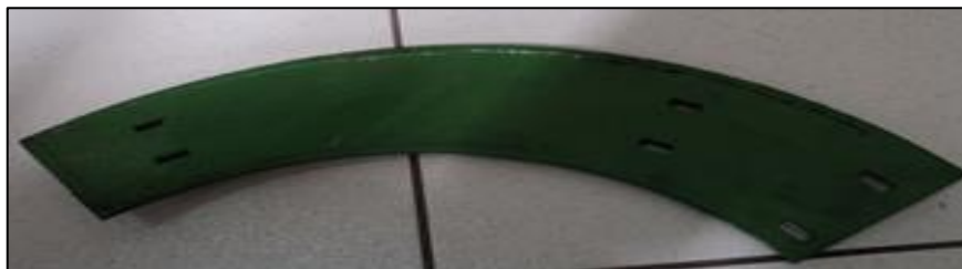
Figura 22 - Chapa de aumento do sem-fim do caracol Fonte: Autoria própria
