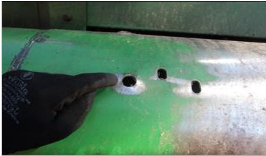
Figura 25 - Desmontagem dos dedos do caracol Fonte: Autoria própria.
