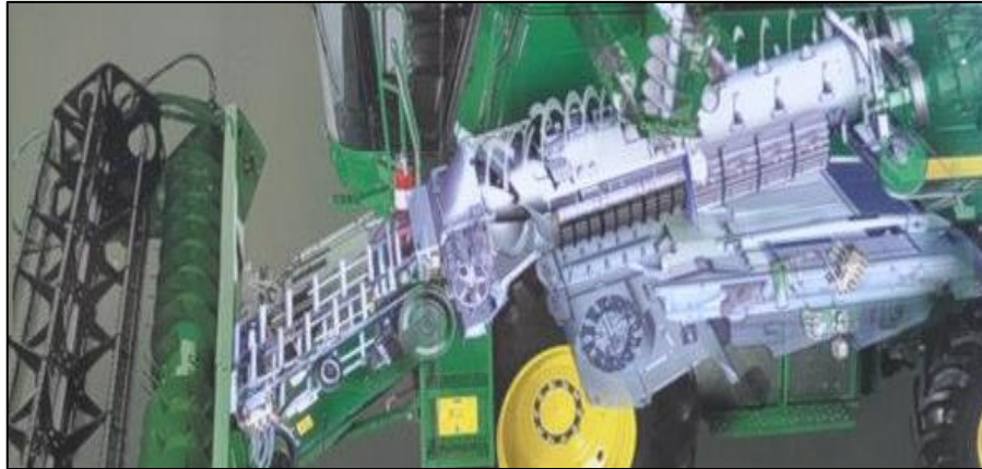
Figura 3 - Sistemas de limpeza de grãos Fonte: Adaptado de John Deere (2014).
