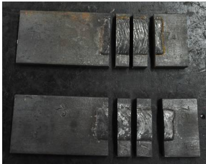
Figura 25 – Foto extração das amostras
