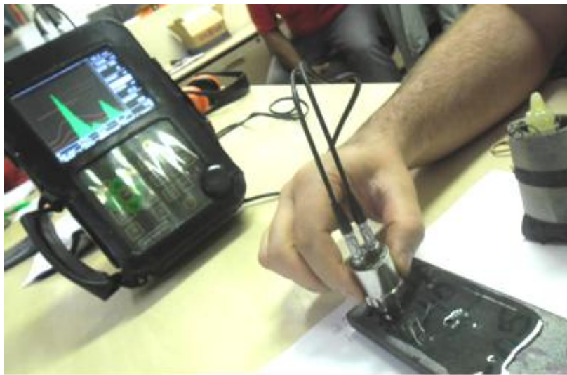
Figura 22 – Foto inspeção por ultrassom
