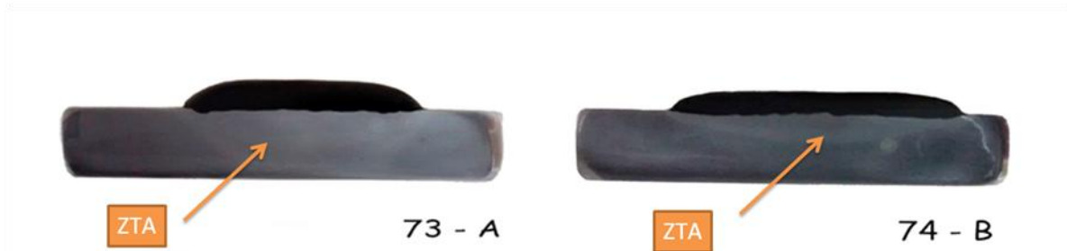
Figura 27 – Zona Termicamente Afetada
