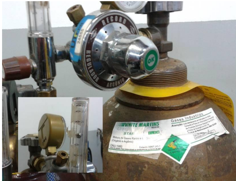
Figura 18 – Foto cilindro de gás de proteção Ar – 2% O 2 Fonte: Autoria própria. (2014)
