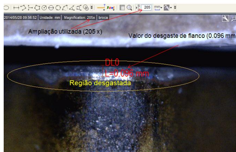
Fotografia 8 - Fotografia de desgaste de franco da ferramenta de corte de torneamento (205 x) Fonte: Autoria própria.
