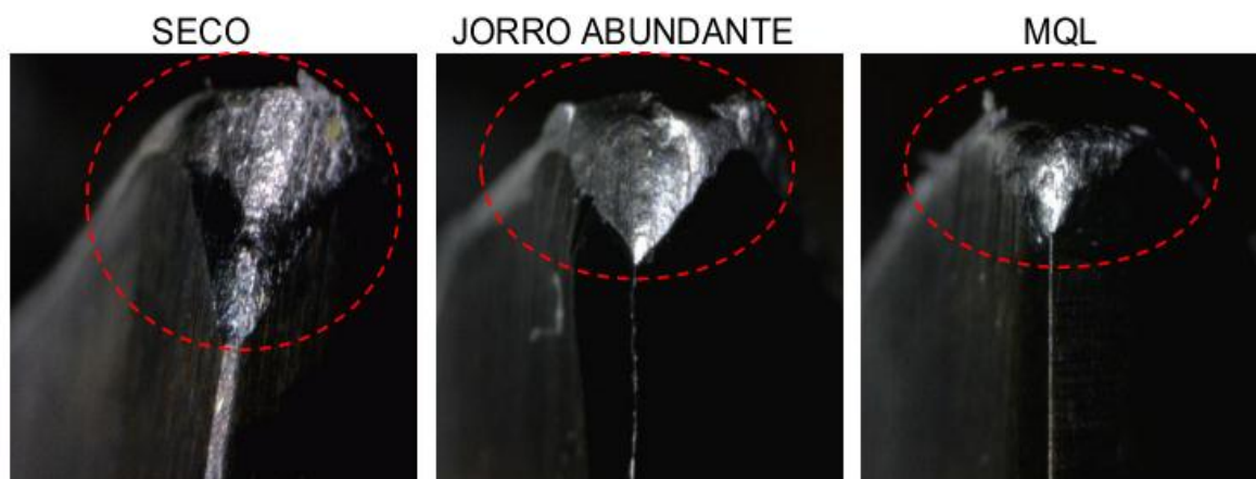
Fotografia 21 - Detalhes do desgaste da ferramenta de rosqueamento Fonte: Autoria própria.
