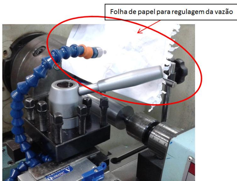
Fotografia 4 - Ajustagem da vazão do MQL observando as borrifadas na folha Fonte: Autoria própria.
