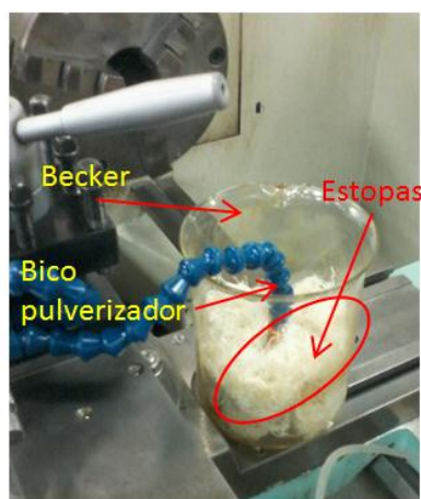
Fotografia 5 - Estimativa da vazão pelo peso do fluido Fonte: Autoria própria.
