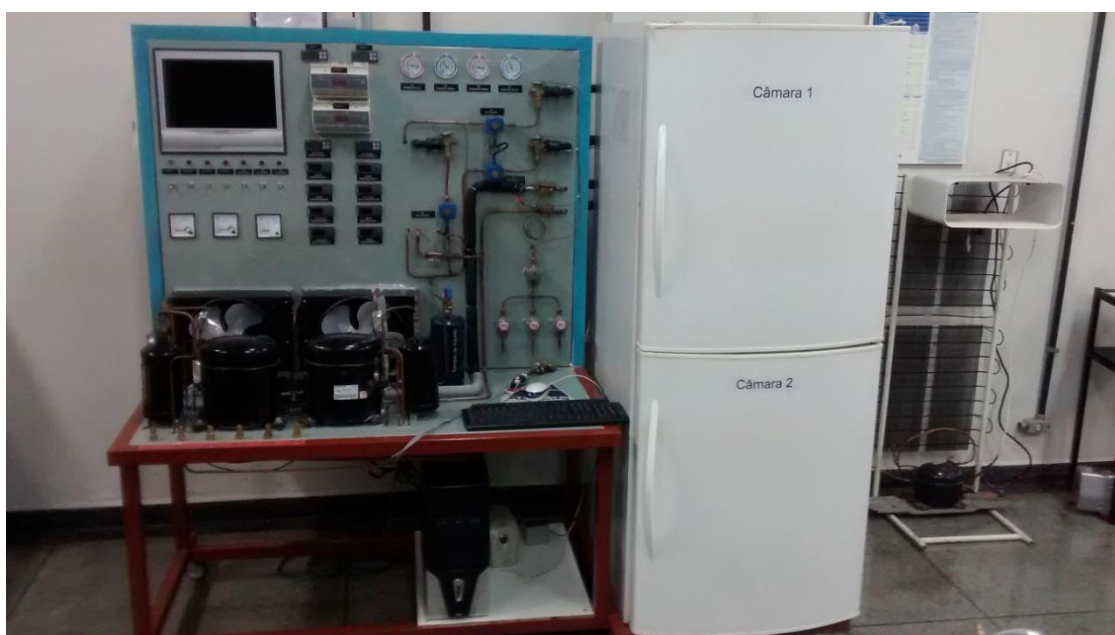
Figura 1 – Bancada de refrigeração e multipressão Fonte: Autoria própria.
