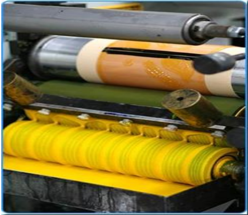
Figura 1 -- Sistema de impressão em clichê
