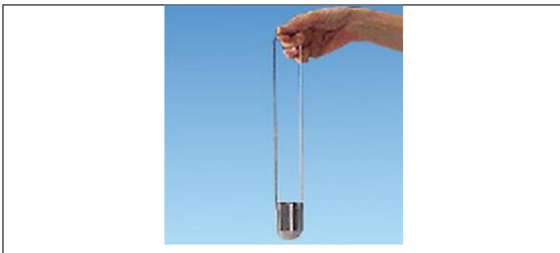
Figura 6- Copo Ford, instrumento de medição de viscosidade manual.
