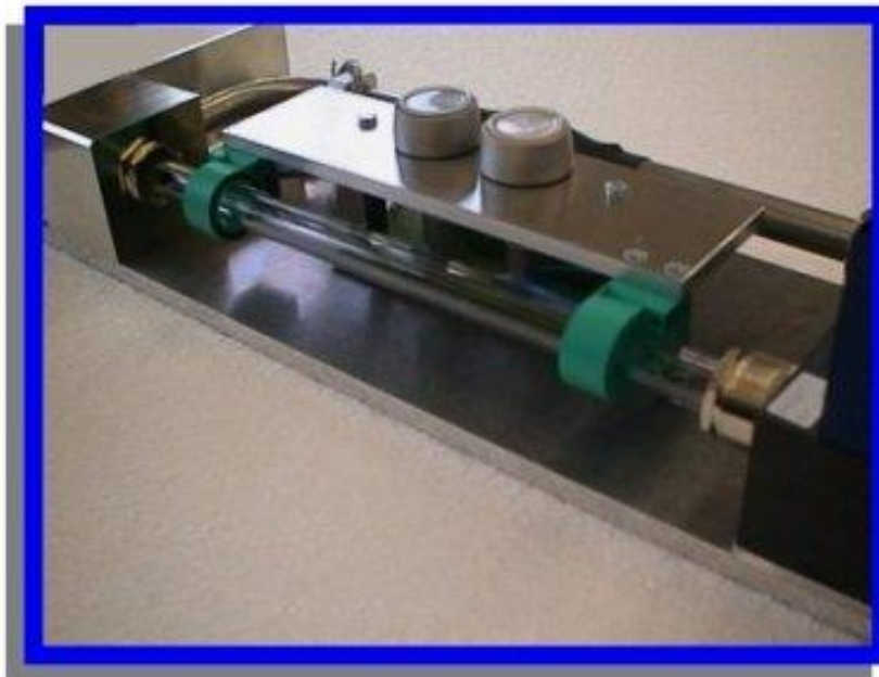
Figura 2- Aparelho de medição: viscosímetro
