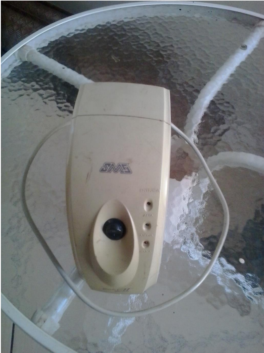
Figura 18 - Estabilizador utilizado para garantir a estabilidade da tensão elétrica.
