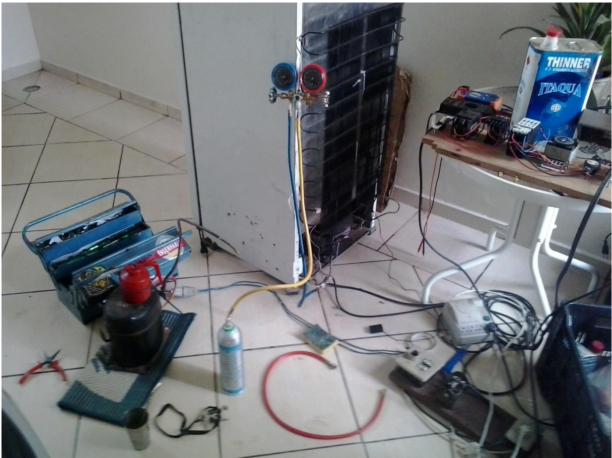
Figura 11 - Equipamento recebendo carga de R-600a.
