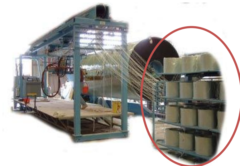
Figura 18 - Fibras dispostas em prateleiras paralelas - FONTE: DIRECTINDUSTRY (2013)
