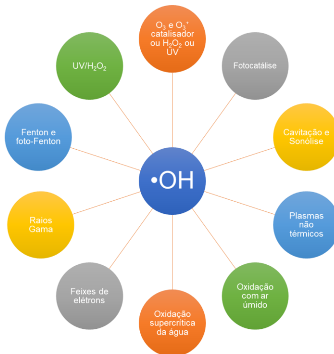
Figura 4 - Formas de obtenção dos radicais hidroxila a partir do POA
