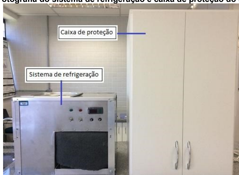
Fotografia 3 - Fotografia do sistema de refrigeração e caixa de proteção do sistema UV/H 2 O 2
