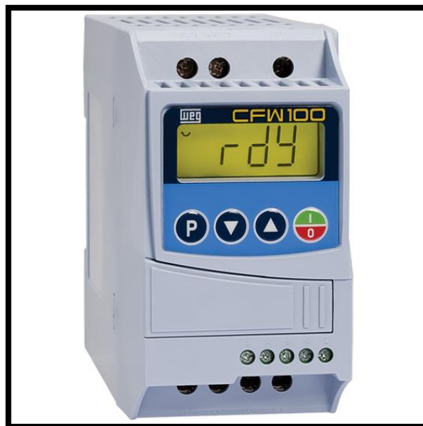
Figura 7 ±Exemplo de inversor de frequência. Fonte: http://www.weg.net .
