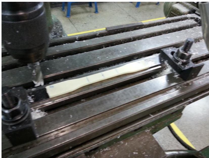
Figura 3.2.11: Fresagem dos corpos de prova.
