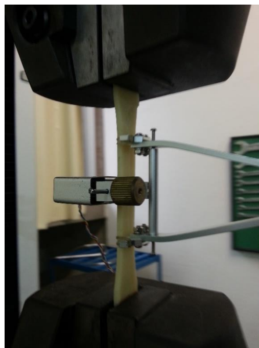
(b) Posicionamento dos extensômetros
