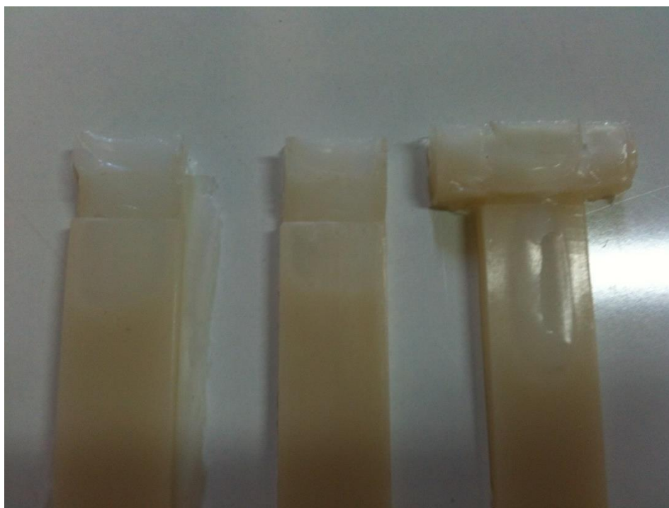
Figura 4.2.1: Corpos de prova com má formação.
