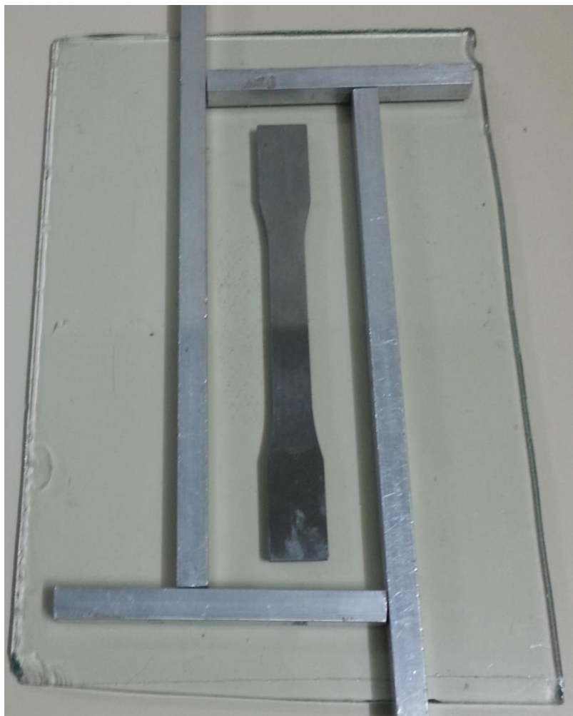
Figura 3.2.3: Preparação da caixa do molde.
