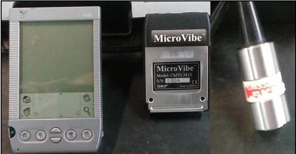
Figura 29 – Palmtop, analisador de vibrações SKF CMVL 3810 e acelerômetro SKF.
