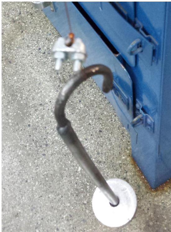
Figura 16 - Fio de cobre com laço para pendurar os pesos
