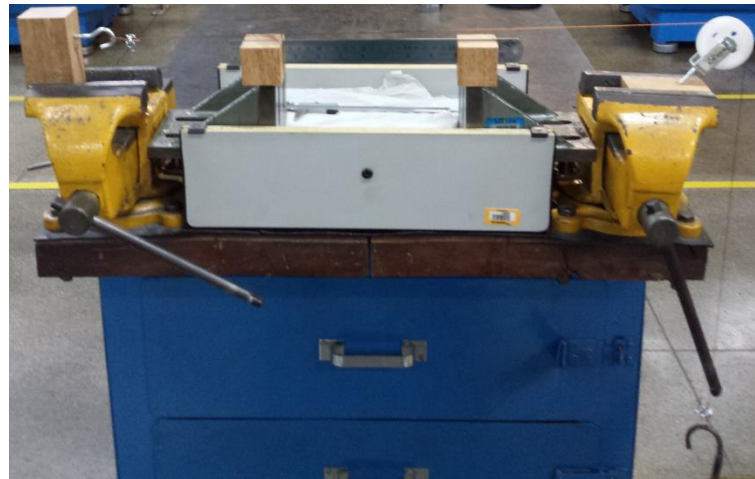
Figura 14 - Arranjo esquemático para o ensaio do fio de cobre
