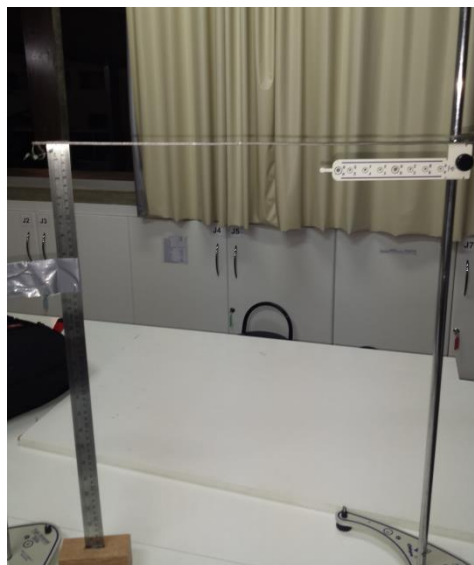
Figura 19 - Arranjo esquemático para obtenção de E do aço 1020
