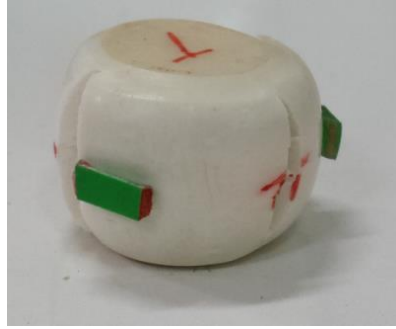
Figura 13 - Corpo de prova achatado após o fim do experimento
