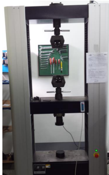
Figura 7 - Máquina utilizada para se realizar o ensaio de compressão
