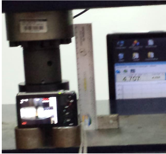
Figura 10 - Corpo de prova na máquina com a câmera o focalizando
