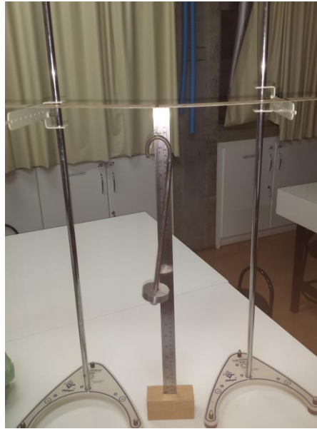
Figura 17 - Arranjo esquemático para o ensaio de flexão do aço INOX
