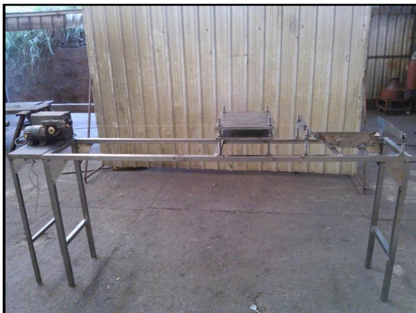
**Figura 17 - Pultrusora durante a fabricação (mínima extensão).**
