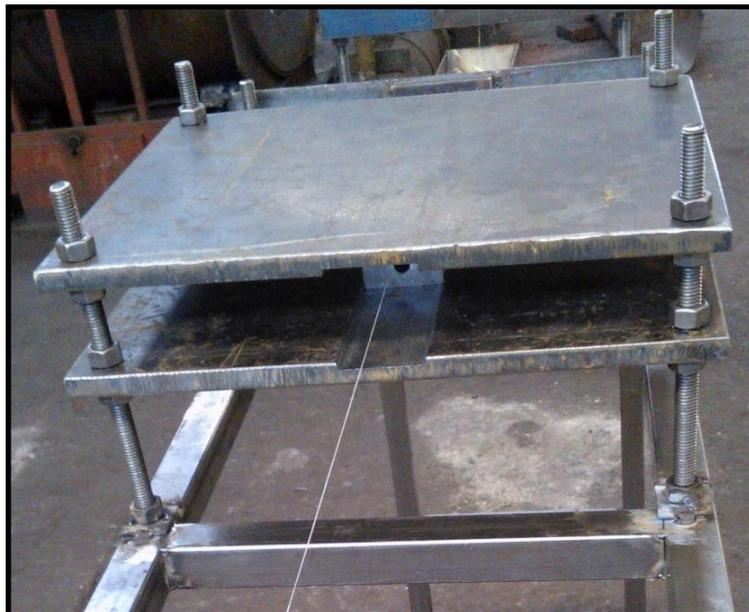
**Figura 23 - Matriz, sistema de aquecimento e fixação.**
