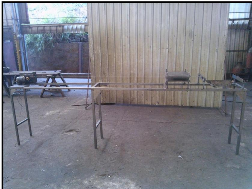
**Figura 18 - Pultrusora durante a fabricação (máxima extensão).**
