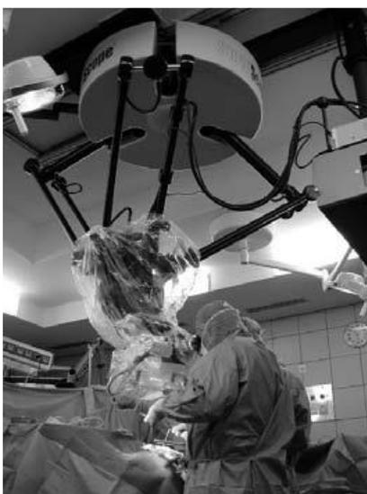
Figura 7 – Manipulador fixo em microscópio
