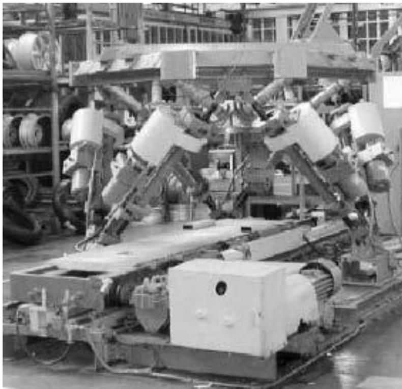
Figura 2 - Protótipo de uma plataforma de Gough
