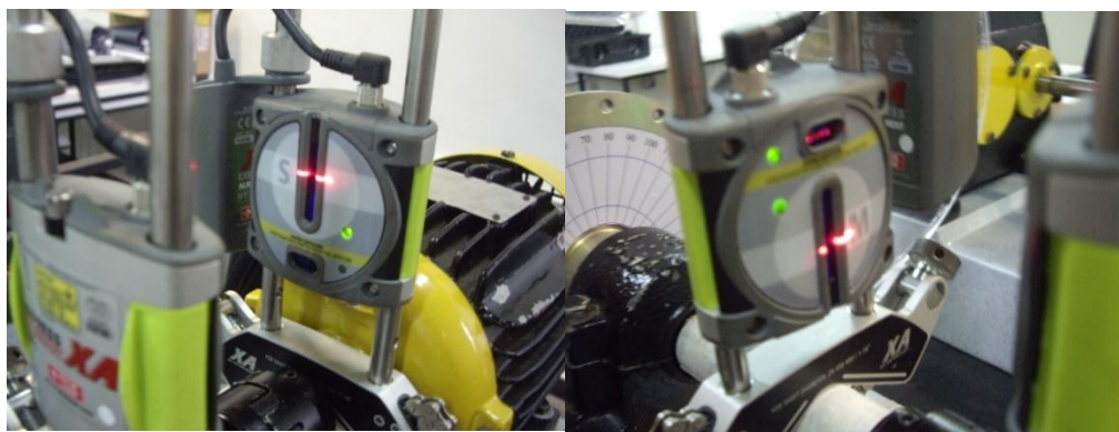
Fotografia 21- Detalhe do laser atingindo o sensor nos dois componentes
