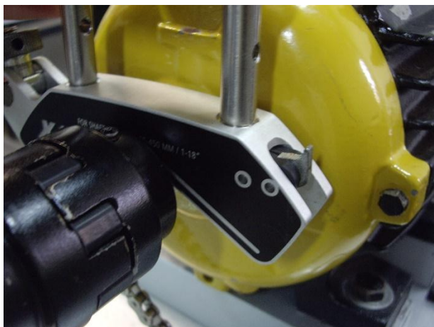
Fotografia 19 – Detalhe do gancho para a corrente. Fonte: Autoria própria
