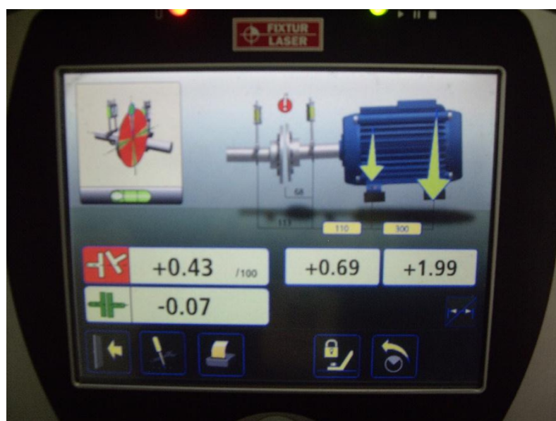
Fotografia 37 – Valores de desalinhamento no plano vertical.
