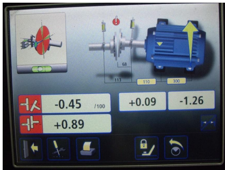
Fotografia 36 – Valores de desalinhamento no plano horizontal.
