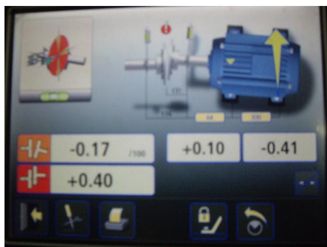
Fotografia 39 – Alinhamento horizontal final Fonte: Autoria própria.
