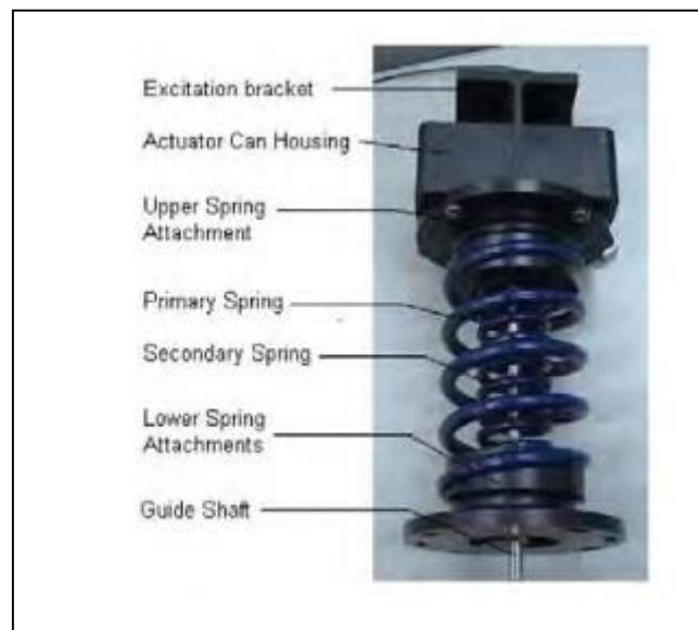
Figura 5 – SmartSprig, aparato usado para controle ativo em sistemas mecânicos.
