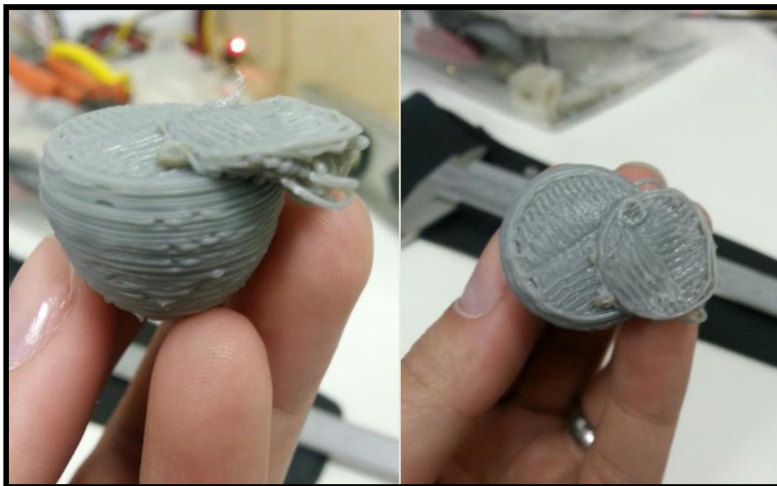
Figura 14 – Impressão com desvios nos eixos. Fonte: Autoria própria.
