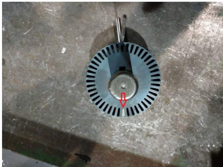
Figura 12 - Barra do rotor rompida por completo
